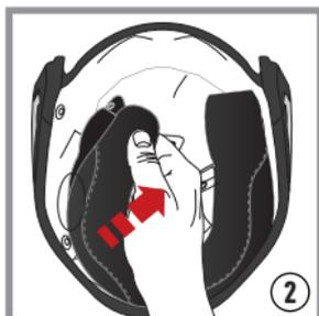
Para volver a montar las protecciones de las mejillas, introduzca la barra de plástico en sus alojamientos traseros ③ y en las clavijas del lado de la cobertura ④.
