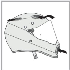
Las tomas de aire frontales y de la mentonera se pueden abrir y cerrar según se desee, mientras que los extractores posteriores, cuya única función es la purga del flujo, están siempre abiertos y garantizan una salida del aire proporcional del aire proporcional al aumento de la velocidad.
