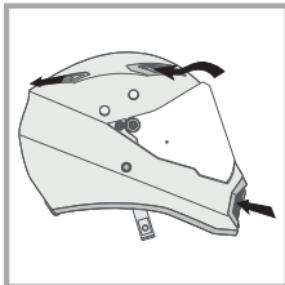
Les prises d'air frontales et celles situées sur la mentonnière peuvent s'ouvrir et se fermer lorsque l'utilisateur le désire, tandis que les extracteurs postérieurs servant uniquement à évacuer le flux d'air, sont toujours ouverts et garantissent une sortie de l'air proportionnelle à l'augmentation de la vitesse.
