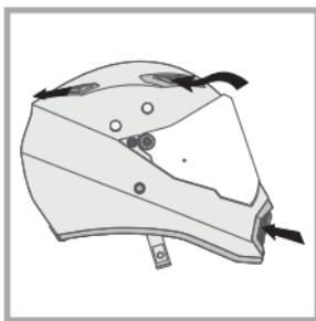
Die vorderen Belüftungsöffnungen können nach Belieben geöffnet und geschlossen werden, während die rückseitigen Luftaustritte, die nur dem Ableiten des Luftstroms dienen, stets geöffnet sind und ein Ausströmen der Luft proportional zur Steigerung der Geschwindigkeit garantieren.
