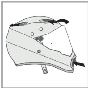
Le prese d'aria frontali e della mentoniera si possono aprire e chiudere a piacimento, mentre gli estrattori posteriori, con sola funzione di sfogo del flusso, sono sempre aperti e garantiscono una fuoriuscita dell'aria proporzionale all'aumentare della velocità.
