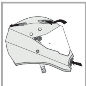
Las tomas de aire frontales y de la mentonera se pueden abrir y cerrar según se deseé, mientras que los extractores posteriores, cuya única función es la purga del flujo, están siempre abiertos y garantizan una salida del aire proporcional del aire proporcional al aumento de la velocidad.
