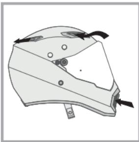
Фронтальные и подбородочные воздухозаборники можно произ- вольно открывать и закрывать, тогда как задние экстракторы, служащие для вентиляции, всег- да открыты и обеспечивают выход воздуха, пропорциональный уве-личению скорости.
