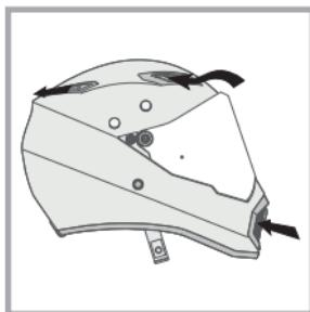
正面进气口和下巴进气口可以按照个人喜 好关闭·而后侧的排气口·只起到排气功 能·并一直处在开启的状态·以保证在车 速提高时·头盔仍可以保持合理排气。
