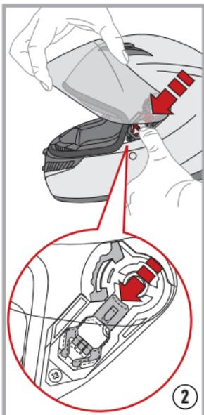
然后将下方卡钩卡进镜片固定插销内（用手指向下推动镜片固定插销开关滑块有助于安装④）。将另一侧镜片用同样的方法安装。结束这个动作后，把镜片关闭下来确认一下是否安装到位。
