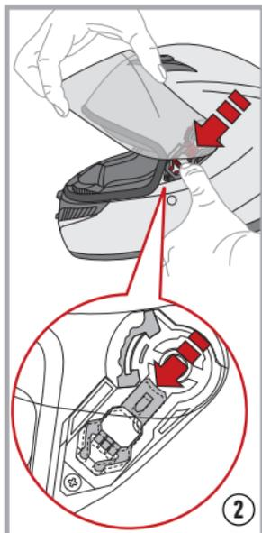
シールドを取り付けるには、ヘルメットの片方から作業を始めます。シールドを完全に一番上まで上げた位置で、着脱レバーを下げた状態で、上部クラスプ(ツメ)をシールドベースの上部クラスプ(ツメ)収容部に挿入します③。
