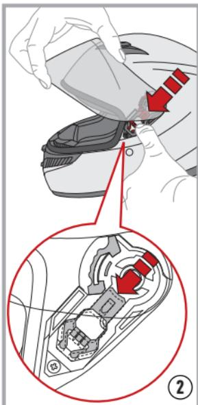
Um das Visier zu installieren, wird von einer Seite des Helms ausgehend und bei vollständig angehobenem Visier, der obere Eingriff des Visiers in seinen Sitz der Grundbewegung ③ eingeführt.
